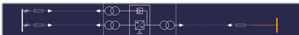
Figur 5 - UPS med statisk switch og separat tilførsel statisk switch. Interne transformatorer på inngang, utgang og i krets til statisk switch.
