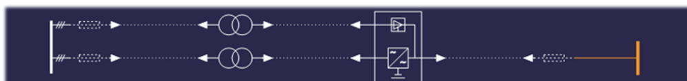
Figur 4 - UPS med statisk switch og separat tilførsel statisk switch. Eksterne transformatorer på inngang og i krets til statisk switch.
